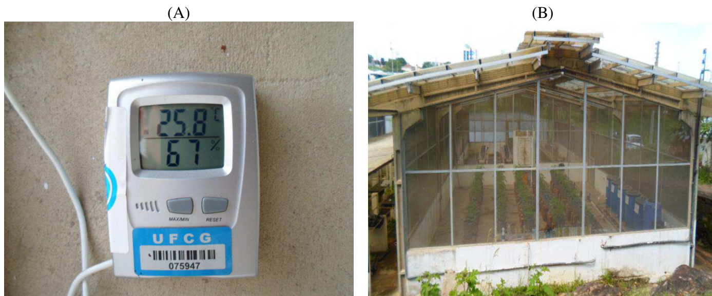
Figura 4 - Termo higrômetro digital para medir temperatura e umidade relativa do ar máxima, média e mínima (A) e vista da casa de vegetação (B).
