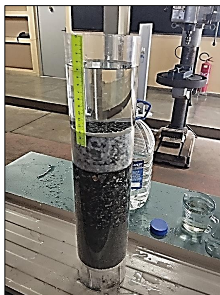
Figura 31 - Infiltrômetro modelado com uma das estruturas de camadas sobrepostas Fonte: Autor
