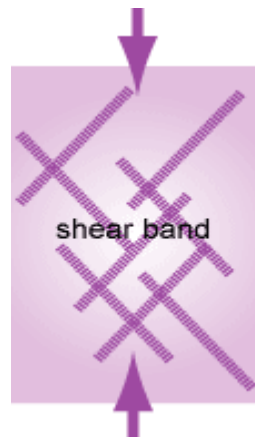
Figura 3: Banda de cisalhamento em polímero que não contém cargas. Fonte: www.specialchem4polymers.com
