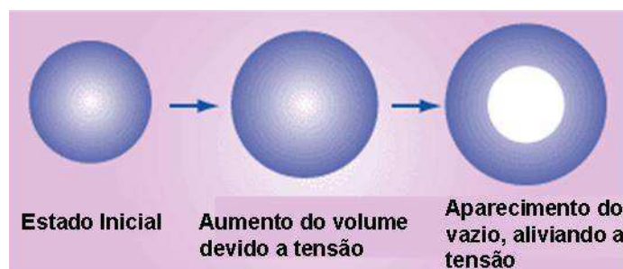
Figura 5: Cavitação de uma partícula de borracha. Fonte: www.specialchem4polymers.com
