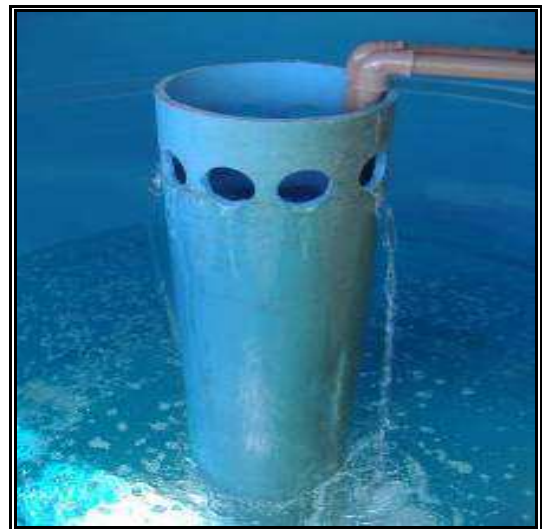
Figura 5.1.2 – Misturador em funcionamento (SILVA, 2008).
