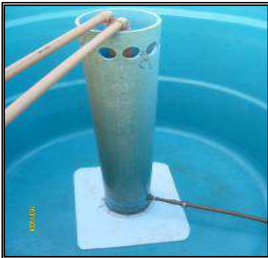
Figura 5.1.1 – Misturador utilizado na produção da água de alimentação (SILVA, 2008).
