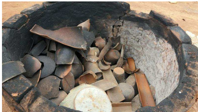
Figura 18. Visão do forno com as peças para serem queimadas, recobertas pelas peças descartadas.
