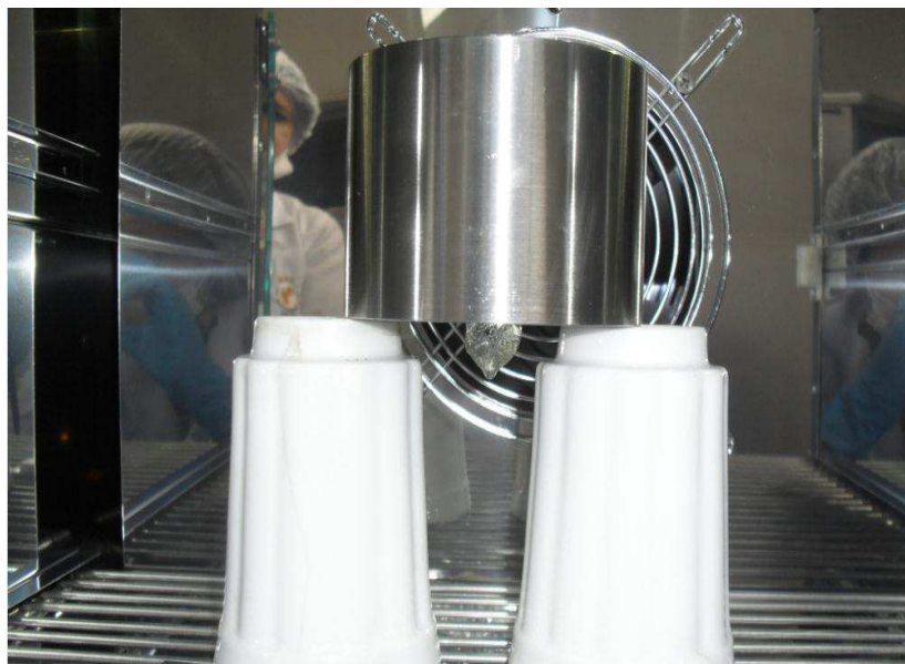
Figura 2 - Aparelho usado no ensaio de coesividade do gel de silicone (Fonte: Própria)
