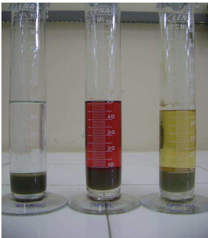
**FIGURA 9** – Inchamento de Foster da argila Verde-Lodo organofílica nos solventes: tolueno, diesel e gasolina (sem agitação).
