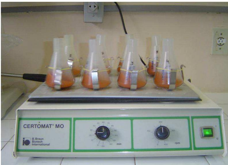
**FIGURA 10** – Equipamento shaker com controle de agitação.
