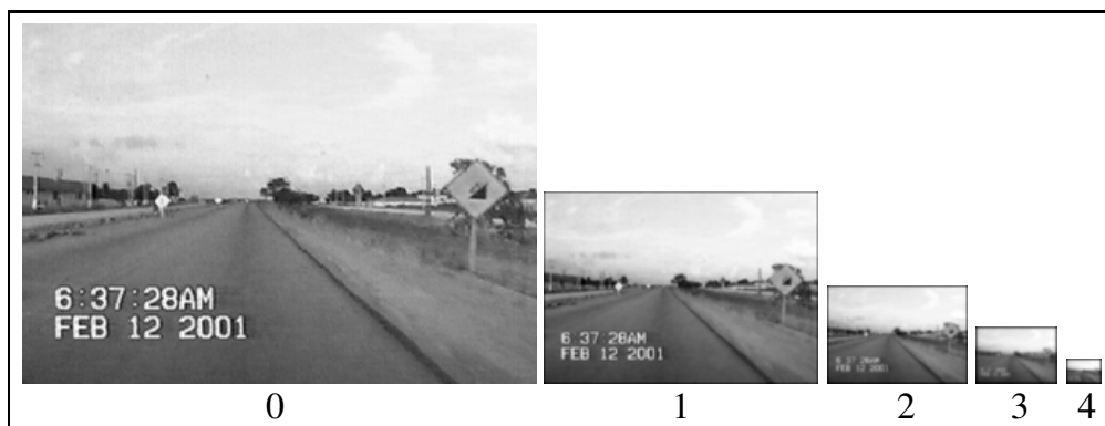
Figura 5.4: Exemplo de uma pirâmide Gaussiana com cinco níveis, gerada a partir de uma imagem de intensidades (Figura 5.3(b)).
