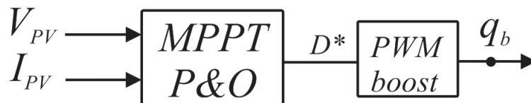
Fig. 4.2 Controle do MPPT para o conversor boost
