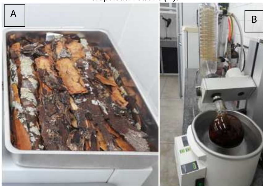
Figura 10: Cascas de Myracrodruon urundeuva Fr. Allemo (A). Concentração do extrato em evaporador rotativo (B).
