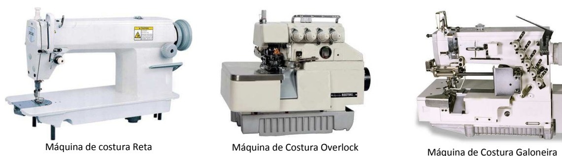
Figura 13. Exemplos de máquinas de costura industrial disponíveis histórica e atualmente no SENAI Caruaru
