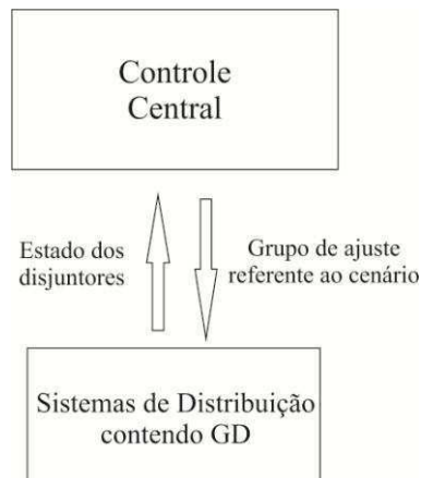
Figura 4.3. Procedimento de seleção dos ajustes dos relés.
