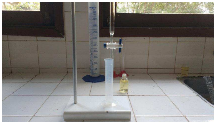
Figura 19. Equipamentos utilizados para determinação da porosidade das sementes de colza ( Brassica napus L.) incrustadas com bentonita, gesso ou caulim e tratadas com fungicida ou extrato vegetal de pimenta-do-reino. Campina Grande, Paraíba, 2017.
