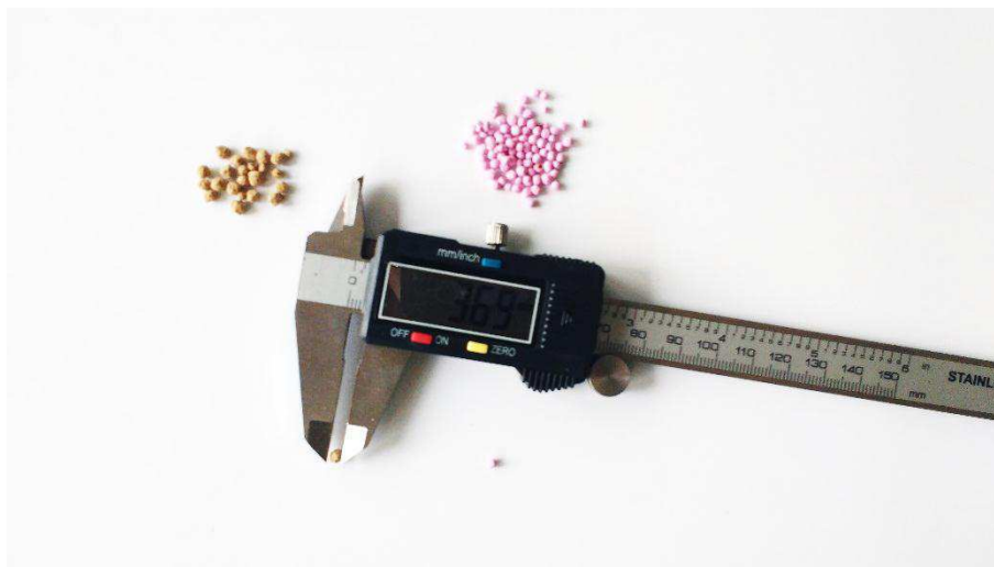
Figura 17. Determinação do diâmetro de sementes de colza ( Brassica napus L.) incrustadas com bentonita, gesso ou caulim e tratadas com fungicida ou extrato vegetal de pimenta-do-reino. Campina Grande, Paraíba, 2017.
