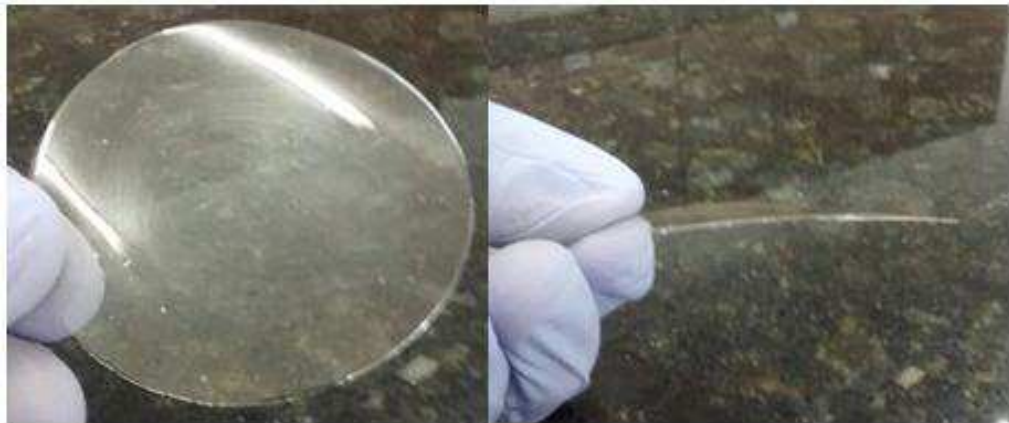
Figura 8 - Membranas de Quitosana (MQ) após evaporação do solvente e antes da neutralização com hidróxido de amônia
