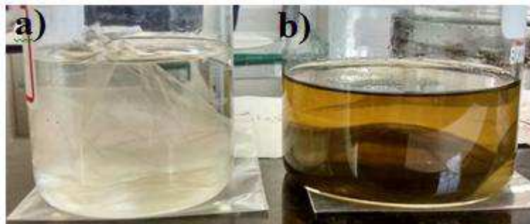
Figura 7 - Reticulação das membranas. a) Reticulação com genipina pura 0,25% (G1); b) Reticulação com o extrato alcoólico do jenipapo (G2).
