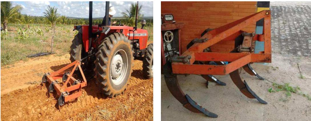
Figura 6 – Preparo do solo com Escarificador de 5 hastes.
