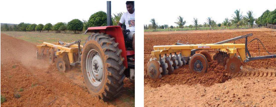
Figura 5 – Preparo do solo com Grade Aradora de 14 discos
