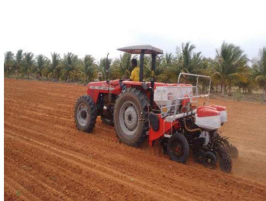
Figura 8 – Semeadora adubadora pneumática de precisão de quatro linhas com espaçamento de 450 mm entre linhas
