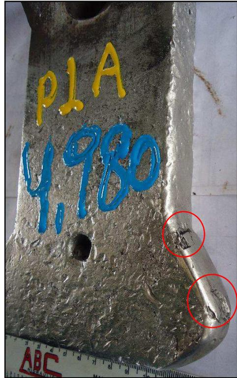
Stellite 1 – PTA-P (corpo de prova A)
