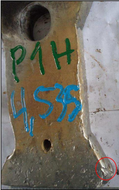
Stellite 1 – PTA-P (corpo de prova H)
