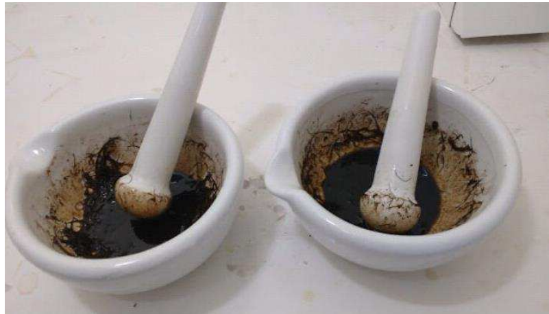
Foto 2 - Almofariz e pistilo utilizados na determinação do teor de lignina
