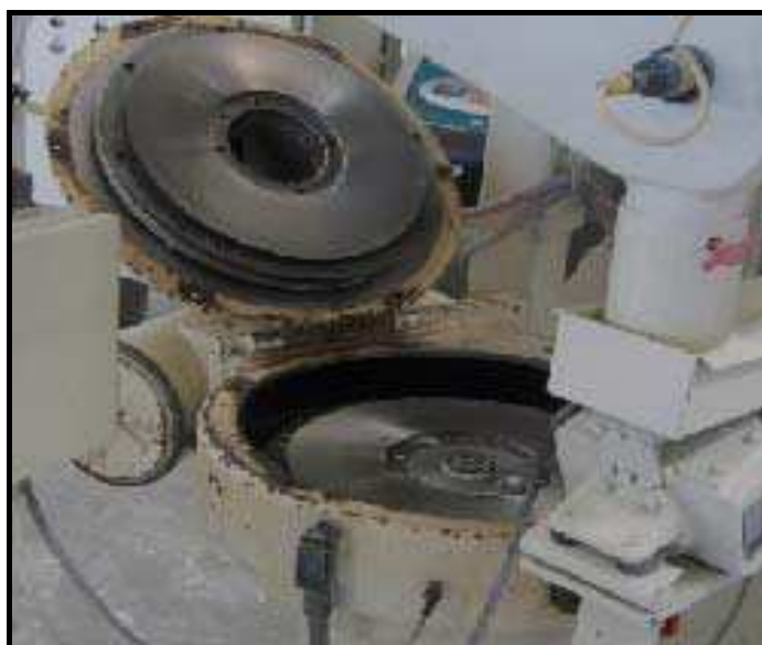
Figura 3-3. Foto dos discos do moinho micronizador.
