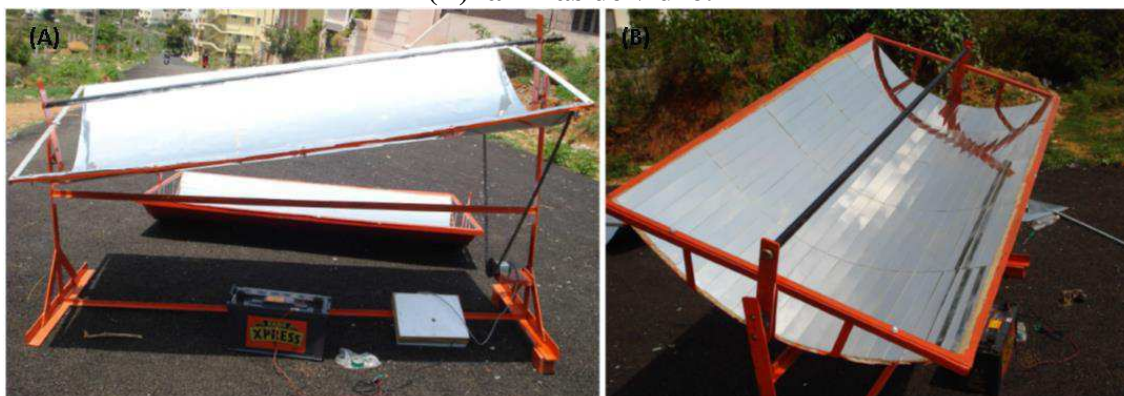
Figura 4.58 - Montagem do coletor com a superfície de refletora (A) Alumínio Polido e (B) lâminas de vidro.
