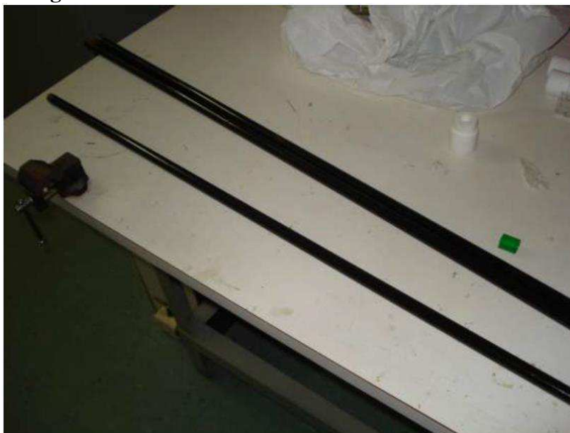
Figura 4.35 - Tubos absorvedores utilizados no coletor
