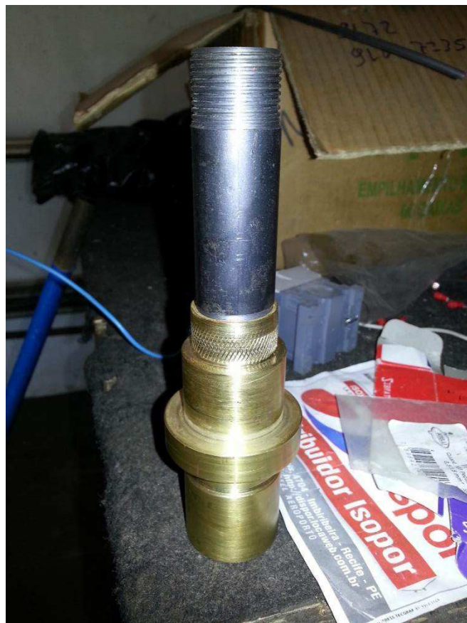
Figura 4.112 - Extremidade do tubo absorvedor acoplado a um tubo para conexão a tubulação do sistema de aquecimento.
