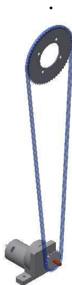
Figura 4.90 - Conceito do atuador utilizado no coletor solar cilíndrico parabólico
