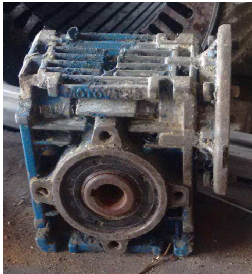
Figura 4.125 - Redutor de velocidade utilizado no sistema de atuação do coletor solar cilíndrico parabólico
