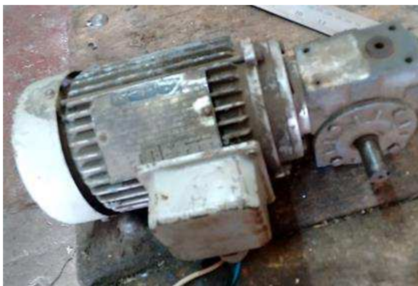
Figura 4.124 - Motoredutor utilizado no sistema de controle do coletor solar cilíndrico parabólico
