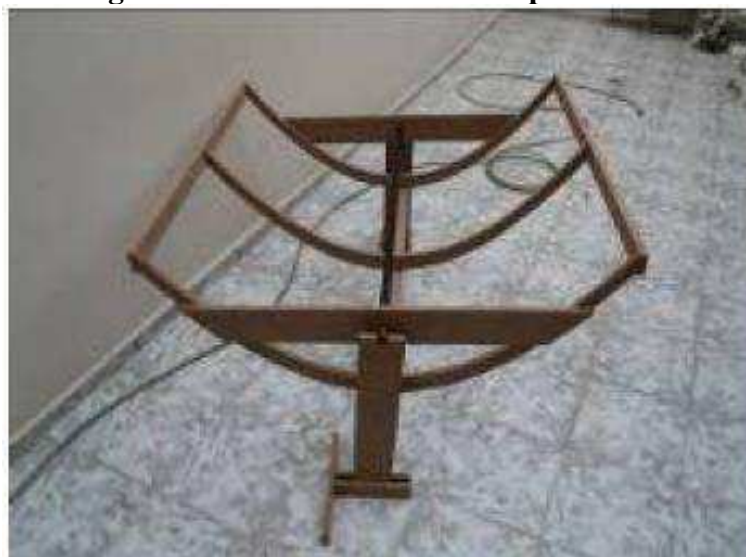
Figura 4.44 - Estrutura da calha parabólica.
