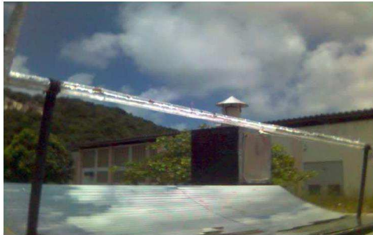
Figura 4.6 - Tubo absorvedor do concentrador proposto.
