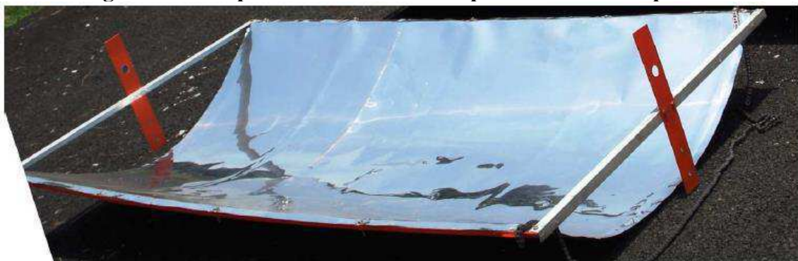
Figura 4.55 - Superfície refletora feita a partir de alumínio polido.
