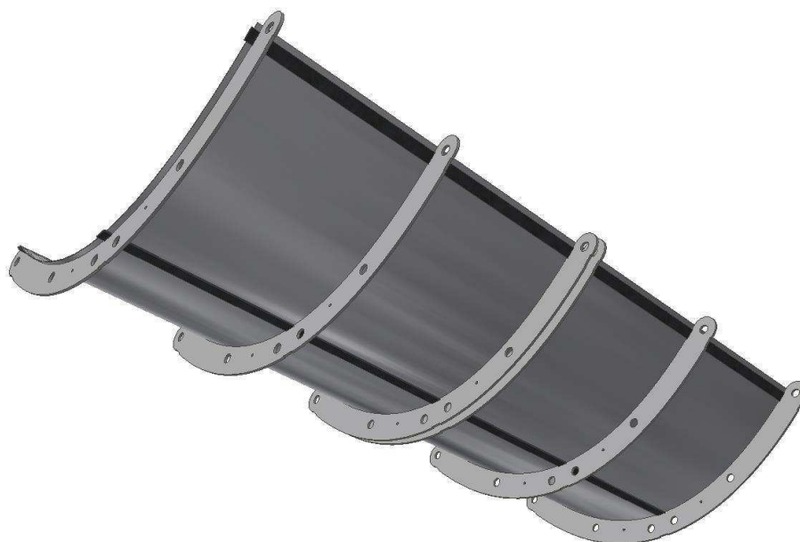
Figura 4.103 - Modelo proposto para a simulação da folha de aço inox utilizada como Superfície Refletora
