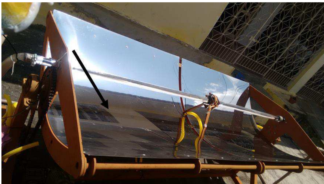
Figura 4.142 - Acurácia do sistema de rastreamento solar do coletor solar cilíndrico parabólico
