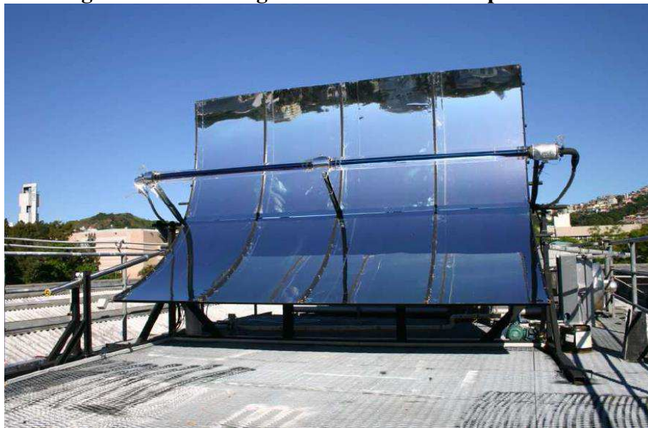
Figura 4.20 - Montagem do coletor cilindro parabólico.
