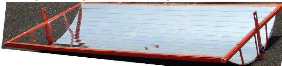
Figura 4.56 - Superfície refletora feita a partir de finas lâminas de vidro.
