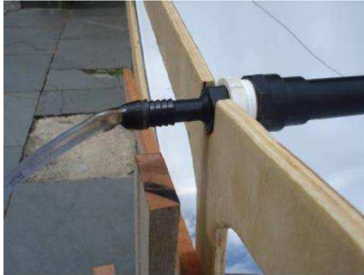
Figura 4.31 - Conexão do tubo absorvedor na estrutura do coletor.
