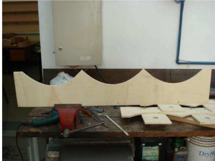
Figura 4.33 - Perfis parabólicos do coletor.
