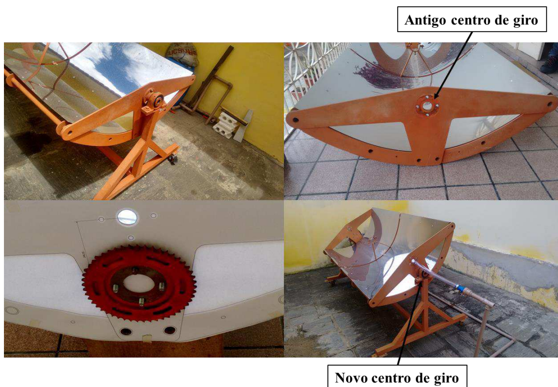
Figura 4.128 - Sequência utilizada para a mudança do centro de giro do coletor solar cilíndrico parabólico
