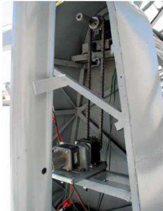
Figura 4.64 - Sistema de correção no posicionamento do coletor solar cilíndrico parabólico.
