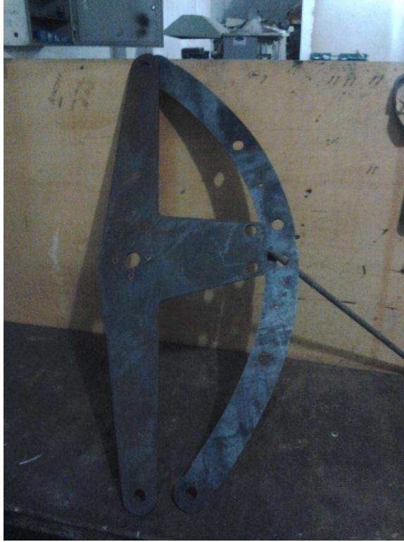
Figura 4.110 - Perfis obtidos no corte a laser.
