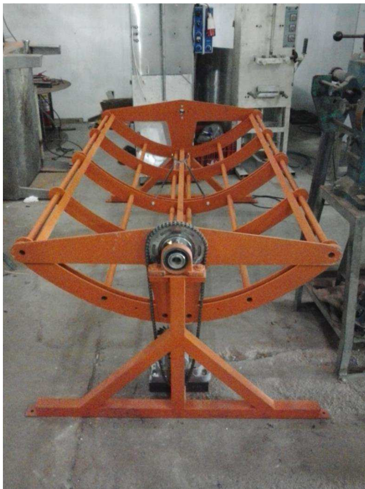
Figura 4.114 - Montagem da estrutura do coletor solar cilíndrico parabólico.
