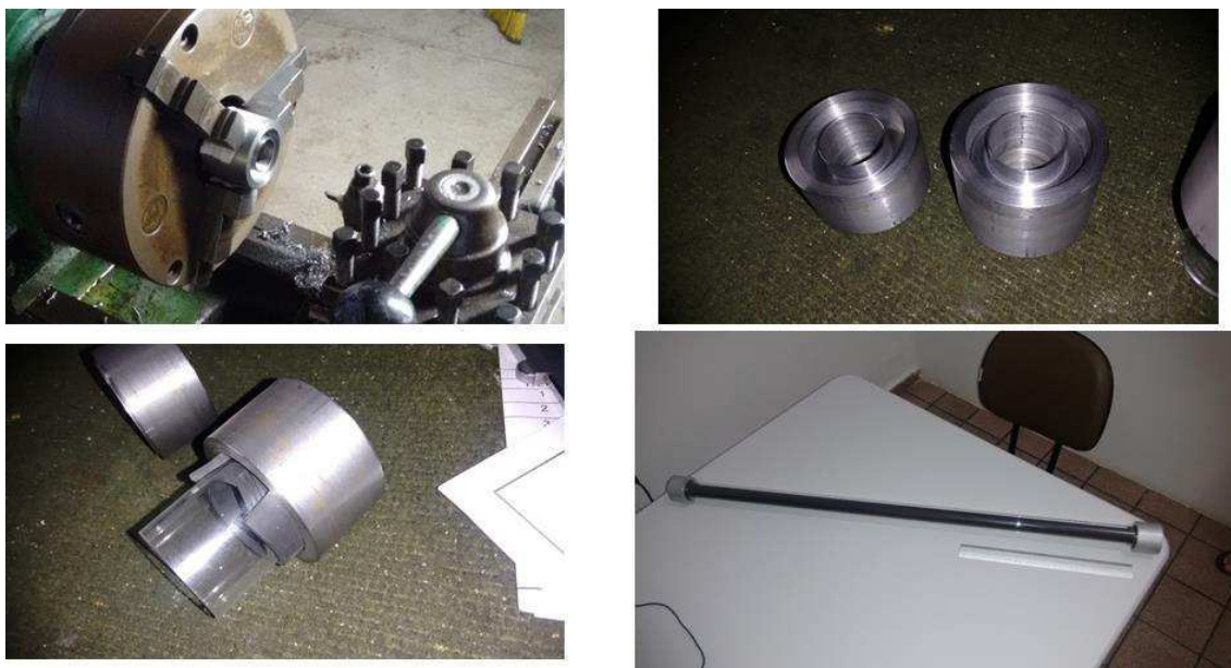
Figura 4.132 - Processo de fabricação do novo Tubo Absorvedor do coletor solar cilíndrico parabólico
