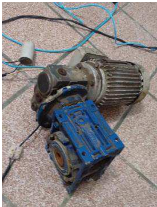
Figura 4.126 - Montagem do motorreductor acoplado a reductor externo
