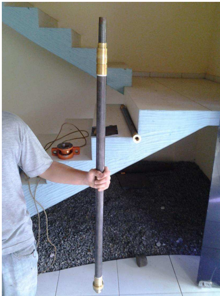
Figura 4.113 - Montagem do tubo absorvedor
