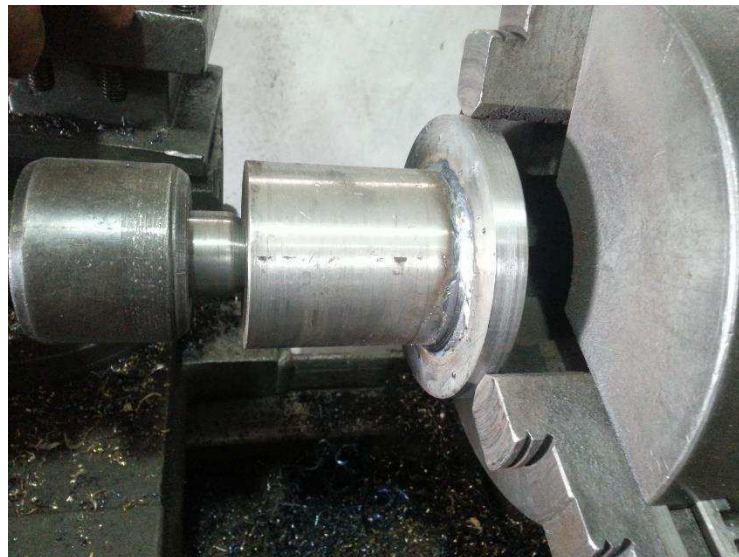
Figura 4.111 - Fabricação do suporte lateral do coletor solar cilíndrico parabólico.
