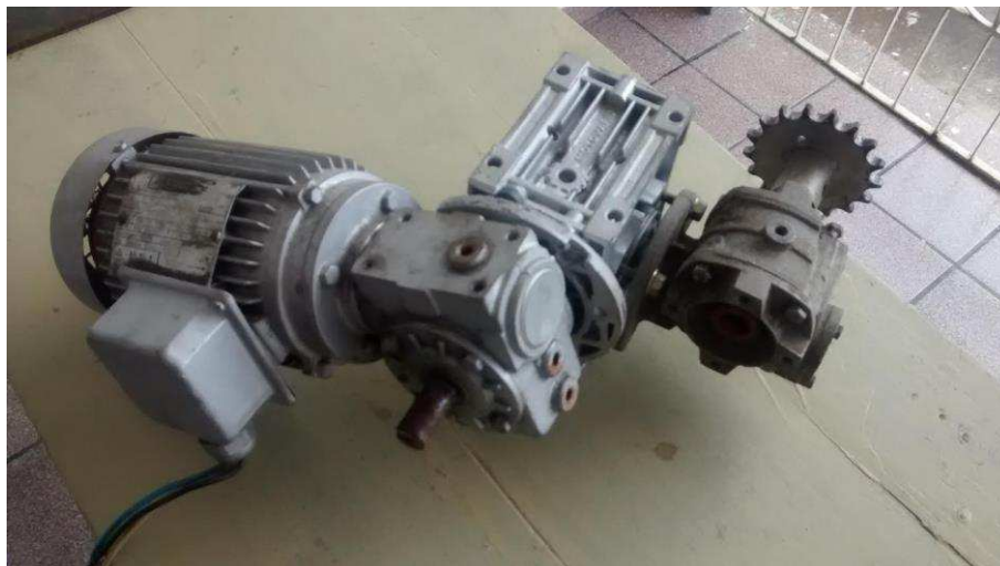
Figura 4.129 - Atuador utilizado no coletor solar cilíndrico parabólico
