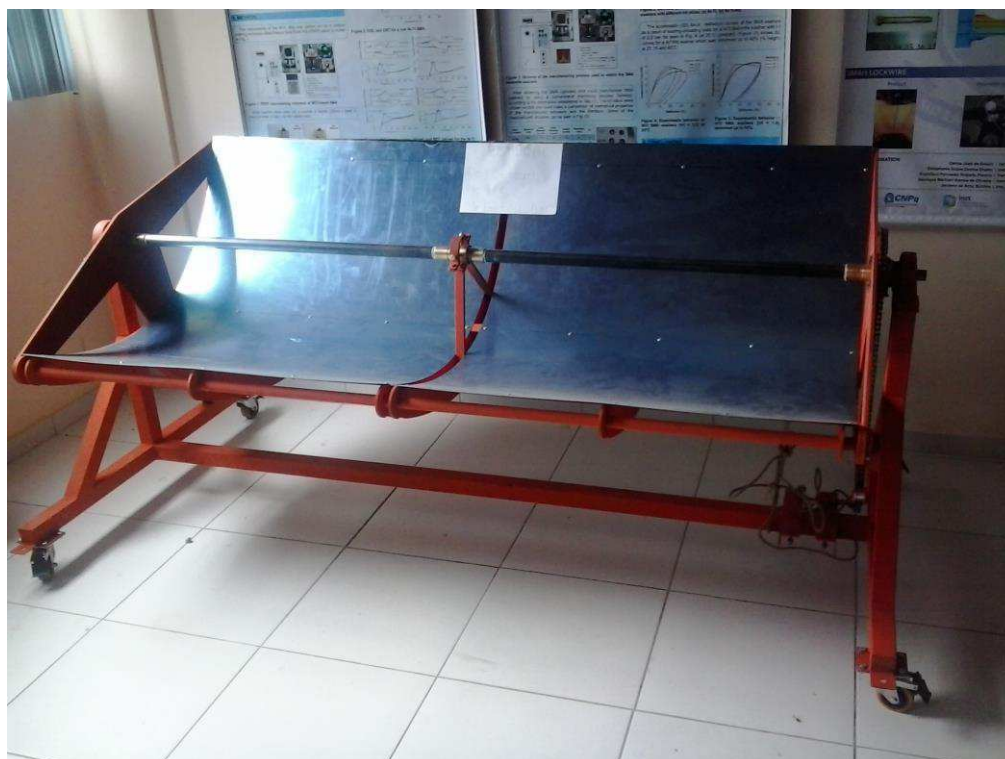
Figura 4.115 - 1º Protótipo do coletor solar cilíndrico parabólico
