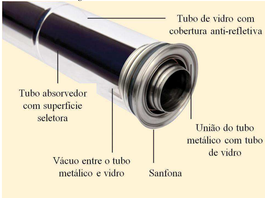
Figura 4.15 - Partes do tubo absorvedor.
