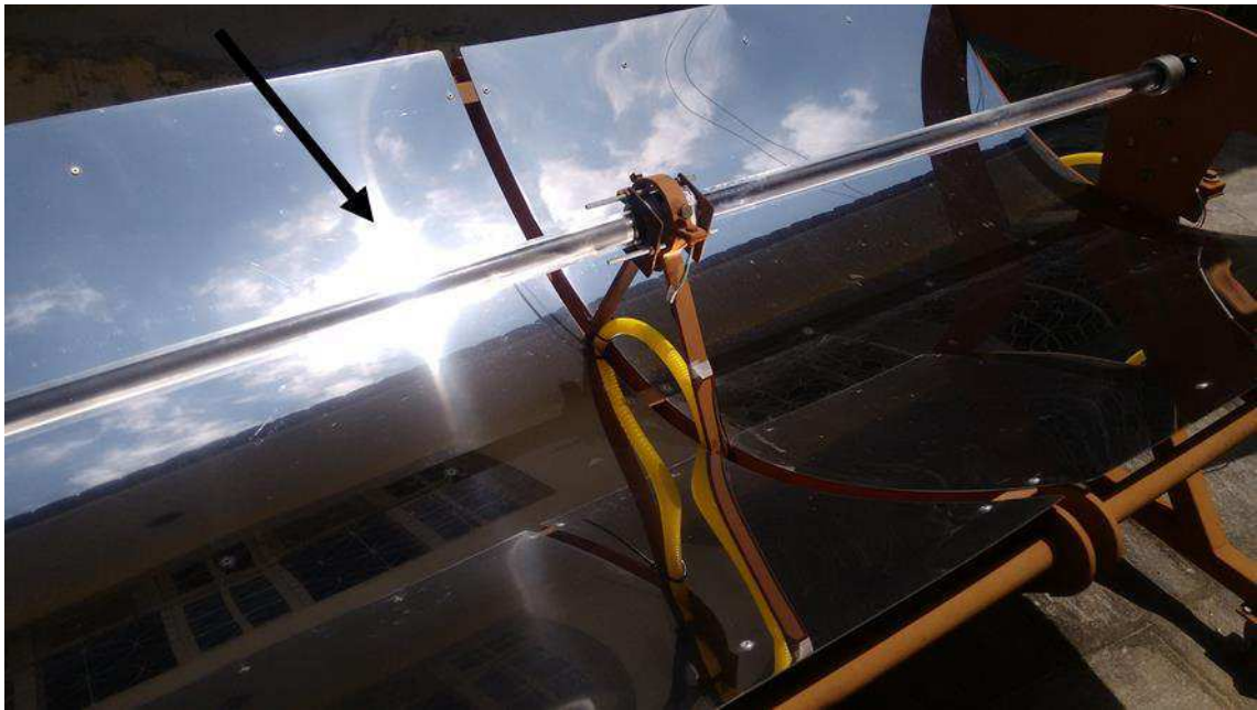
Figura 4.143 - Acurácia da superfície refletiva do coletor solar cilíndrico parabólico
