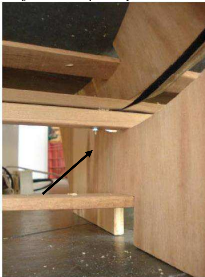
Figura 4.30 - Fixação da superfície refletiva.
