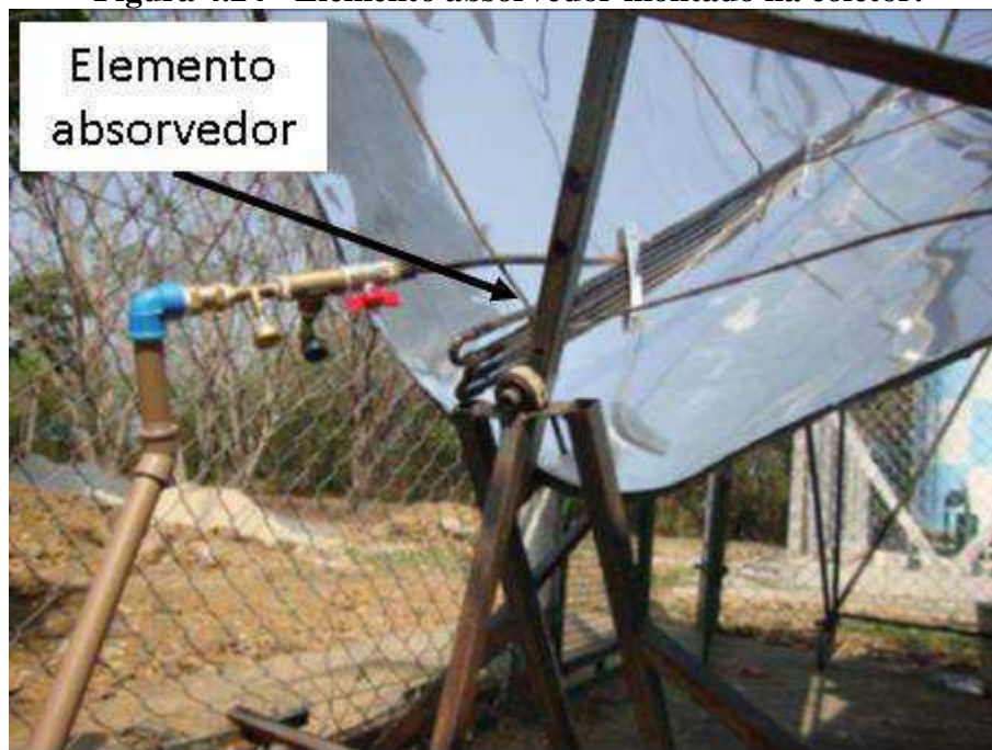
Figura 4.24 - Elemento absorvedor montado na coletor.
