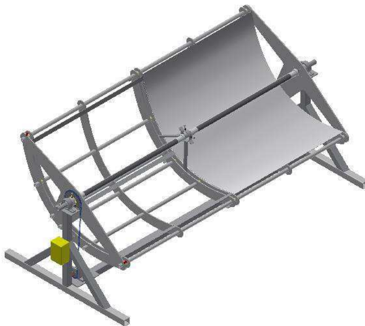
Figura 4.101 - Condição imaginada para as análises de torção na estrutura do coletor solar cilíndrico parabólico.
