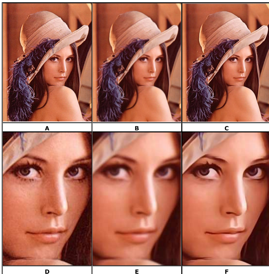
Figura 3.4 - Ilustração do Filtro FABL: (A e D) Imagem Original (800x600 px); (B e E) Imagem filtrada pelo filtro FBL (direção da tangente: sigma espacial = 2.0; sigma radial = 10; direção do gradiente: sigma espacial = 0.6; sigma radial = 0.04); (C e F) Imagem filtrada pelo filtro FABL (direção da tangente: sigma espacial = 2.0; sigma radial = 10; direção do gradiente: sigma espacial = 0.6; LoG(sigma) = 1,2; LoG(vizinhança) = 7x7). Dimensões das imagens: (A, B e C) 800x600 pixels; (D, E e F) 270x180 pixels.
