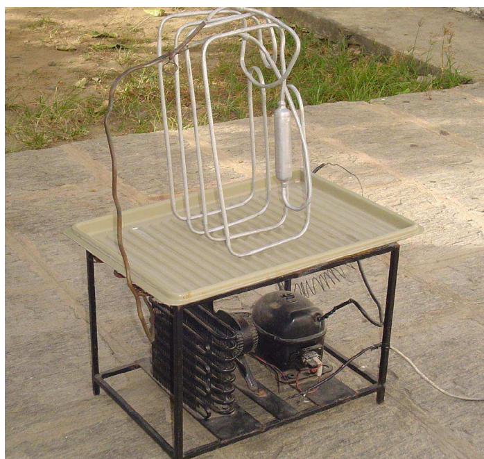
Figura 7 – Compressor, condensador e evaporador, retirados do refrigerador.
