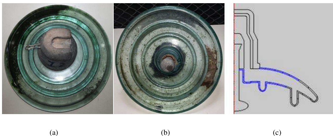
Figura 5.22: Isolador contaminado (a) parte superior, (b) parte inferior e (c) desenho esquemático.
