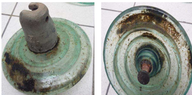
Figura 5.30: Isolador contaminado (a) parte superior, (b) parte inferior.
