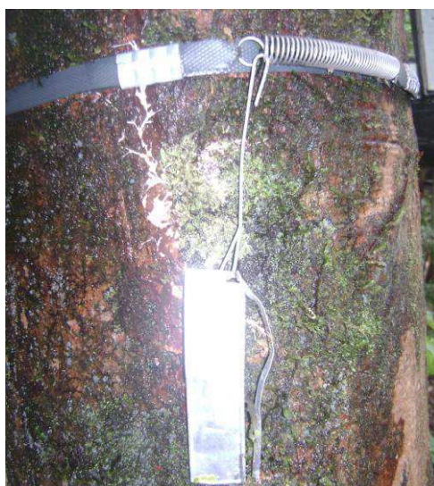
Figura 6. Cinta dendrométrica utilizada para a medição do diâmetro da planta a altura do peito nas duas parcelas experimentais
