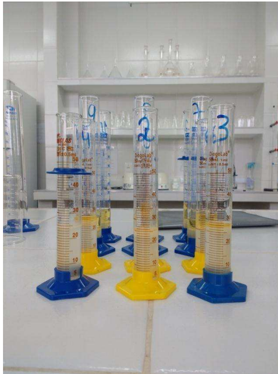
Figura 9 - Aferição volumétrica de volume de gasolina remanescente em proveta.
