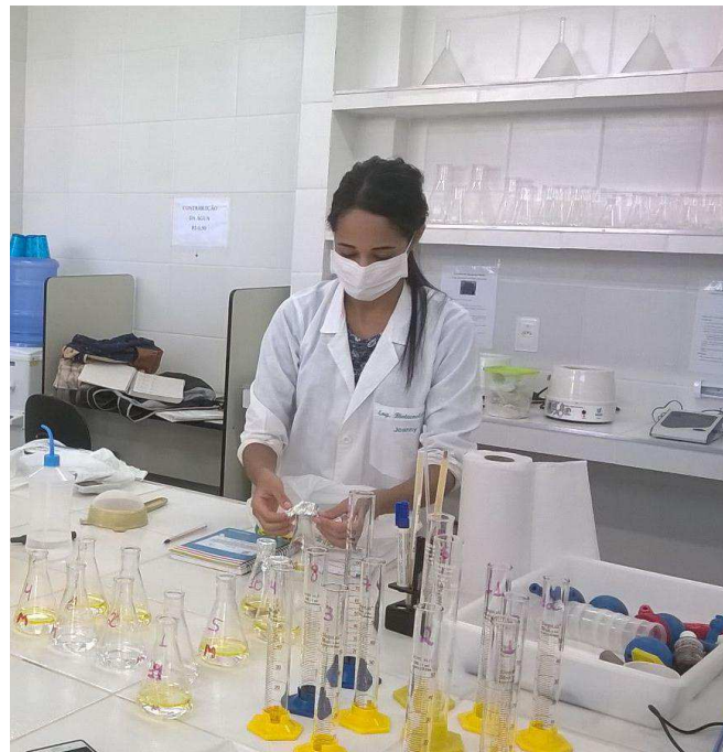
Figura 7 - Preparação dos frascos erlenmeyers com a mistura água/gasolina
