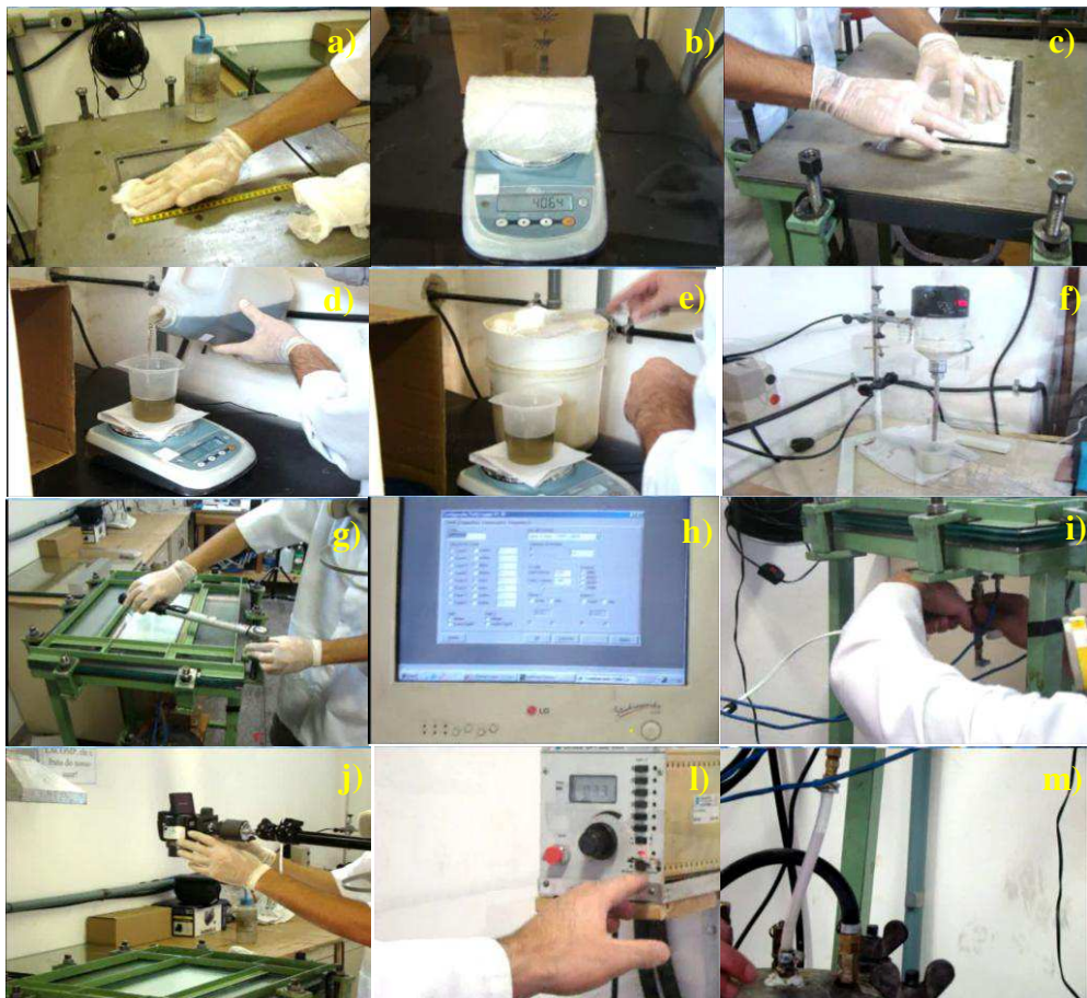
Figura 3.6 - Sequencia esquemática do experimento no RTM: (a) limpeza do molde, (b) pesagem da manta fibra de vidro para calcular V_f , (c) posicionamento da manta no molde, (d) pesagem da resina, (e) pesagem do carbonato de cálcio, (f) agitação mecânica e (g) fechamento do molde, (h) preparo do programa de aquisição de dados, (i) fechamento das válvulas, (j) preparo da máquina fotográfica para registrar o tempo e a posição de injeção da resina, (l) ajuste da pressão de injeção e (m) injeção de resina no molde .
