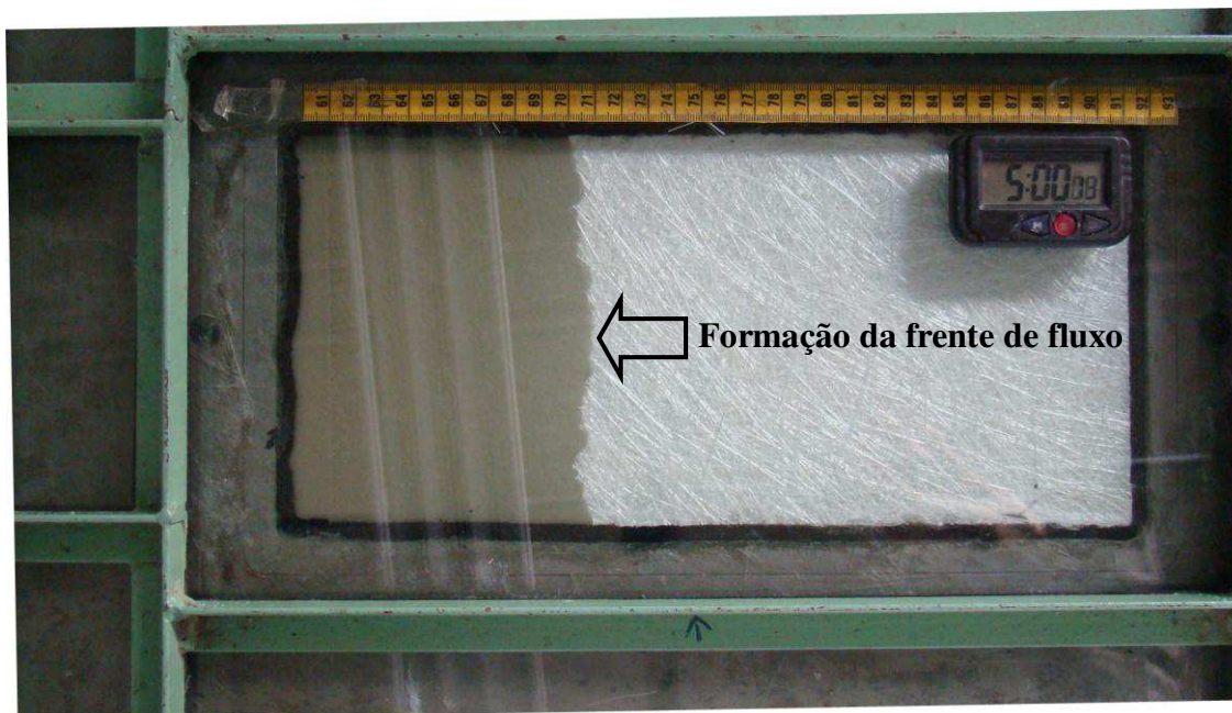
Figura 3.8 - Determinação da permeabilidade através do escoamento retilíneo.
