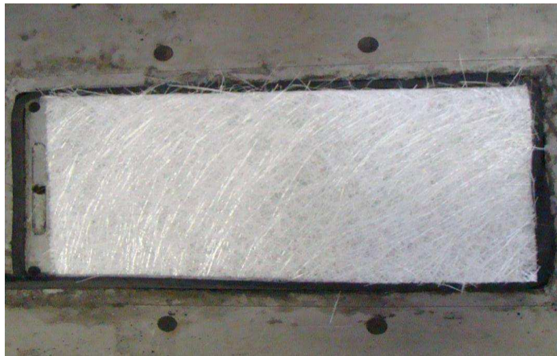
Figura 3.4 - Pré-forma no interior do molde.
