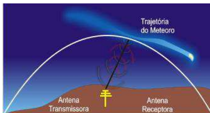
Figura 3.4 – Configuração para o radar mono-estático ( backscatter )
