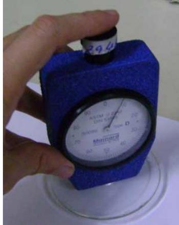
Figura 3.7- Ensaio de dureza, com durômetro Shore Type D, marca Mainard, modelo M-702, DIN 58505. Fonte: Pesquisa Direta, 2010.
