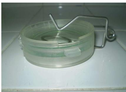
Figura 2.4 – Conjunto de moldes (moldes, junta e presilha). Fonte: Pesquisa Direta, 2010.
