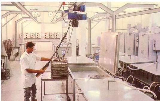
Figura 2.6 – Tanques de termopolimerização. Fonte: Pesquisa direta, 2010.
