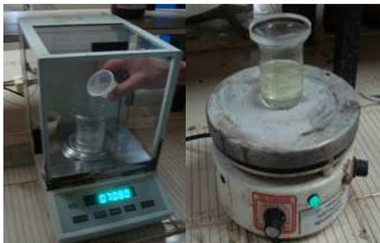
Figura 3.3 – Balança e agitador magnético. Fonte: Pesquisa Direta, 2010.
