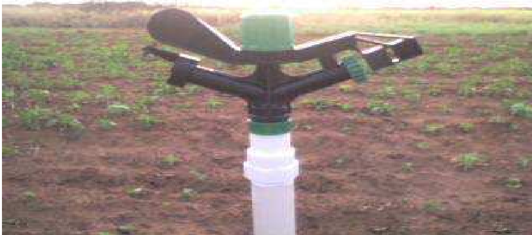
Figura 3.7: Aspersor utilizado na irrigação.
