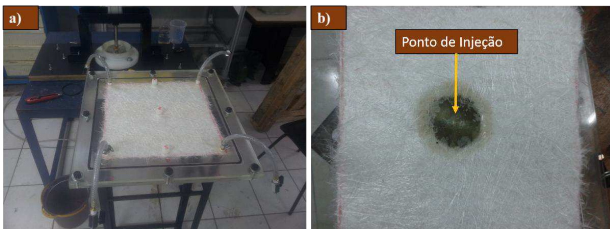
Figura 88 - Primeiro Teste com o Novo Molde: a) Montagem, b) Pequena quantidade de resina injetada.
