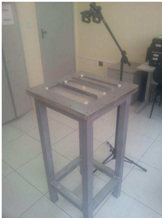
Figura 29 - Suporte do Molde Fabricado para Uso no Processamento por RTM.
