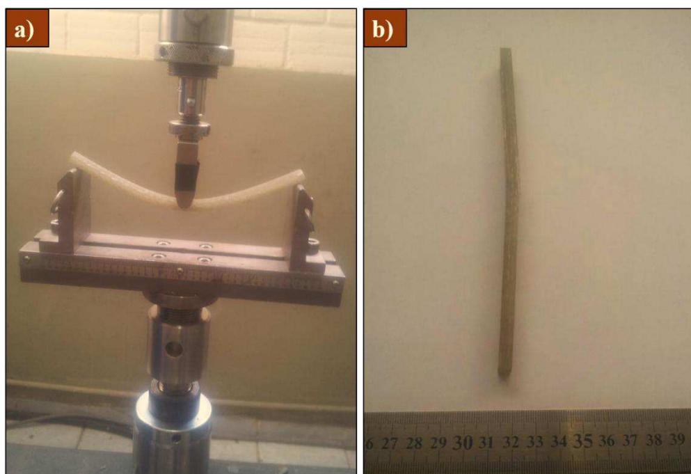
Figura 99 - Fratura do Corpo de Prova Compósito: a) Durante o ensaio e b) Após o ensaio.
