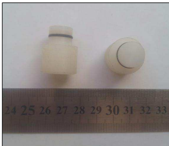
Figura 83 - Vedação tipo Tampa em Processo de Fabricação.
