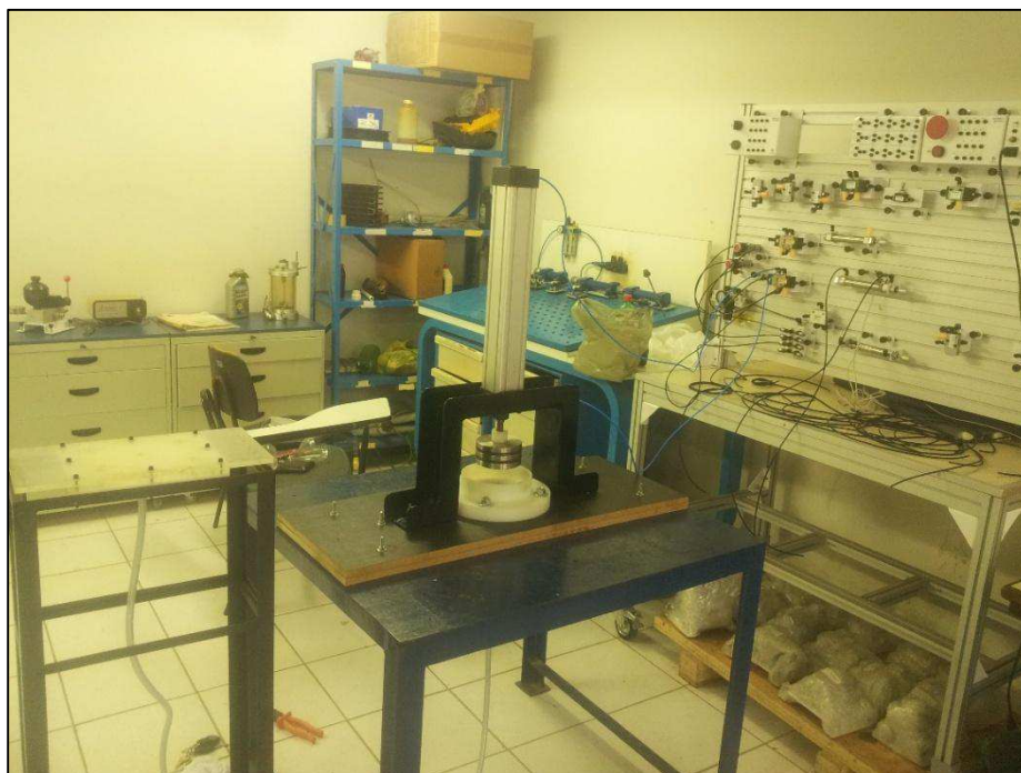
Figura 70 - Equipamento de Injeção de Resina por RTM Concebido.
