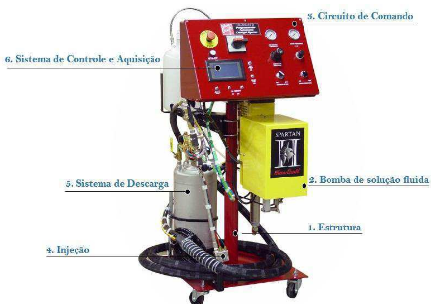
Figura 12 - Equipamento utilizado no processo RTM Típico e seus sistemas.
