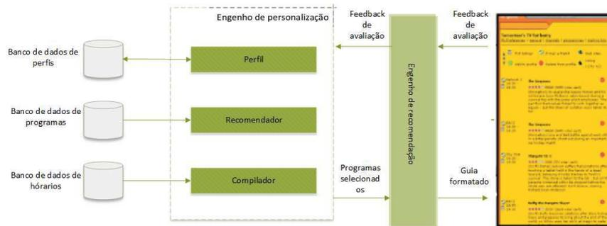
Figura 5.6: Arquitetura utilizada no trabalho: Guia Eletrônico Personalizado de Televisão
