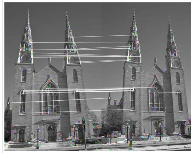
Figura 2.8: Ilustração do processo de detecção de correspondência entre os pontos de interesse entre duas imagens, direita e esquerda, destacando os pontos de interesse correspondentes.
