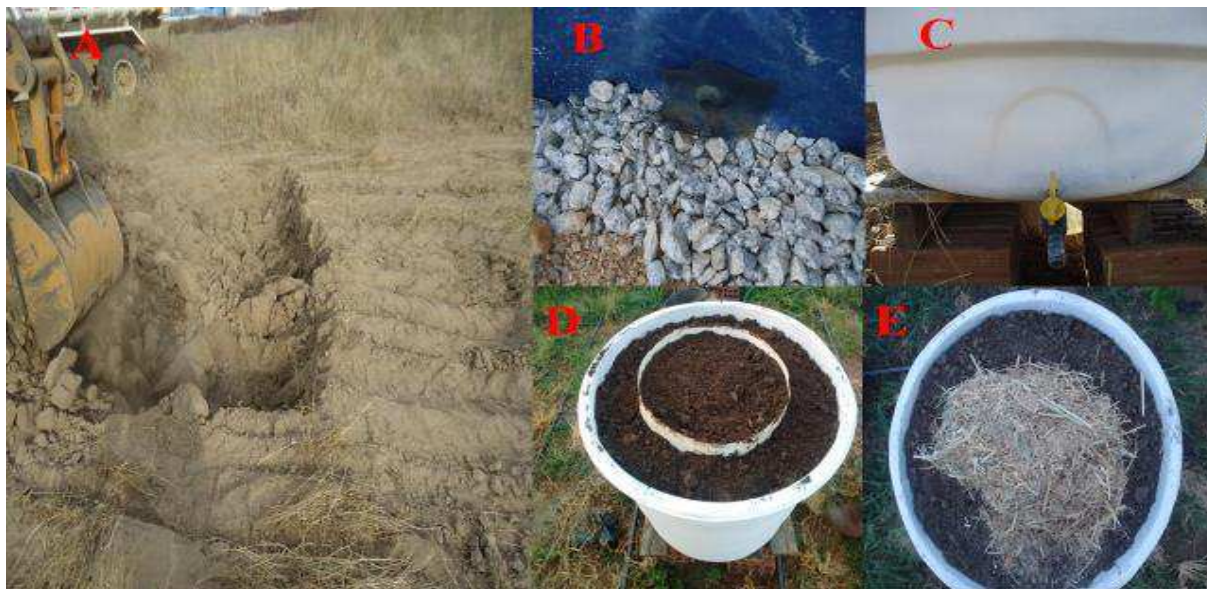
Figura 1. Ilustração da área de coleta do solo para o preenchimento dos lisímetros (A), da camada de brita e areia grossa (B), saída do dreno (C), do enchimento dos lisímetros com o cilindro ao centro (D), da cobertura com palha de milho triturada (E) (SILVA, 2018), CCTA/UFCG, Pombal- PB, 2019.
