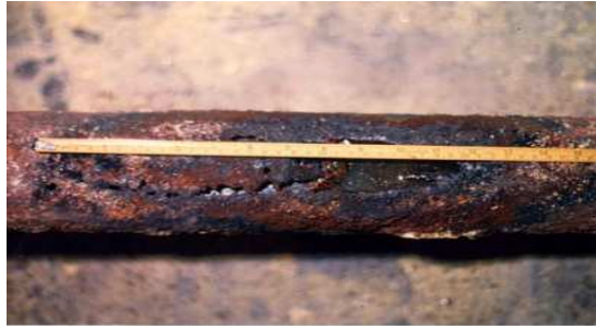
Figura 01 - Corrosão Uniforme em um tubo enterrado.
