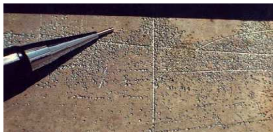
Figura 02 - Corrosão por Pit em Aço Inox.
