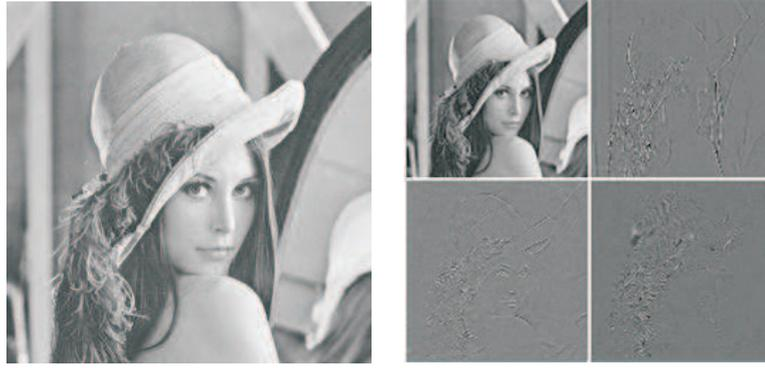
Figura 2.5: Transformada wavelet. Inicia-se com a imagem original e (a) após a transformação, obtêm-se imagens em outras escalas: (b) LL, (c) HL, (d) LH e (e) HH.
