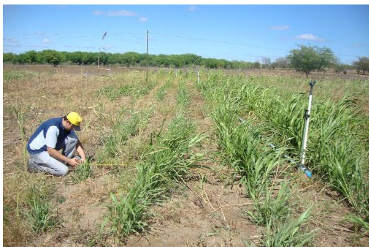
Fonte: Arquivo do autor. Medição para instalação dos recipientes para coleta de precipitação
