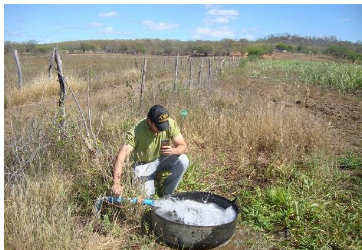
Fonte: Arquivo do autor. Cronometrando a vasão da água
