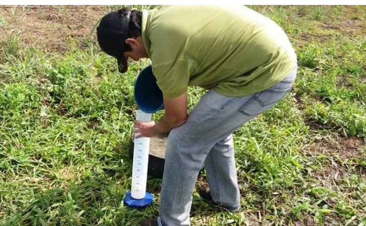
Fonte: Arquivo do autor. Medição da vasão da água
