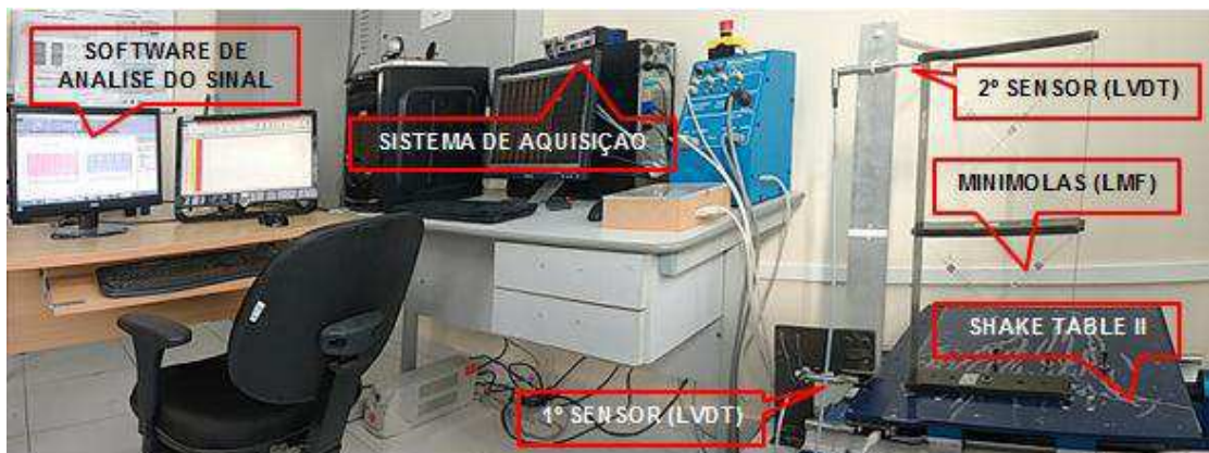
Figura 43 – Montagem experimental do sistema em vibração forçada.
