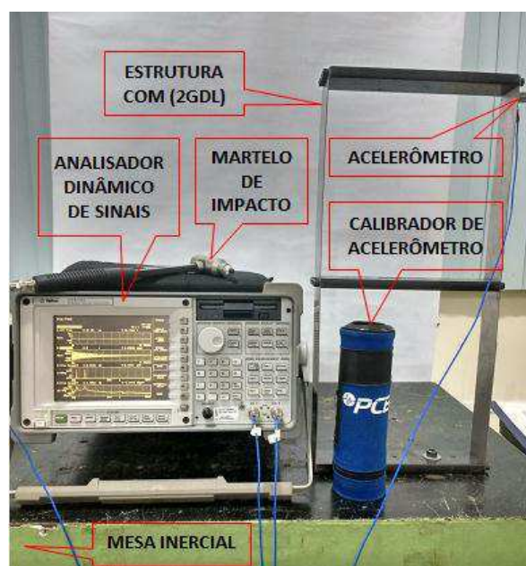
Figura 41 – Montagem experimental da estrutura em vibração livre.
