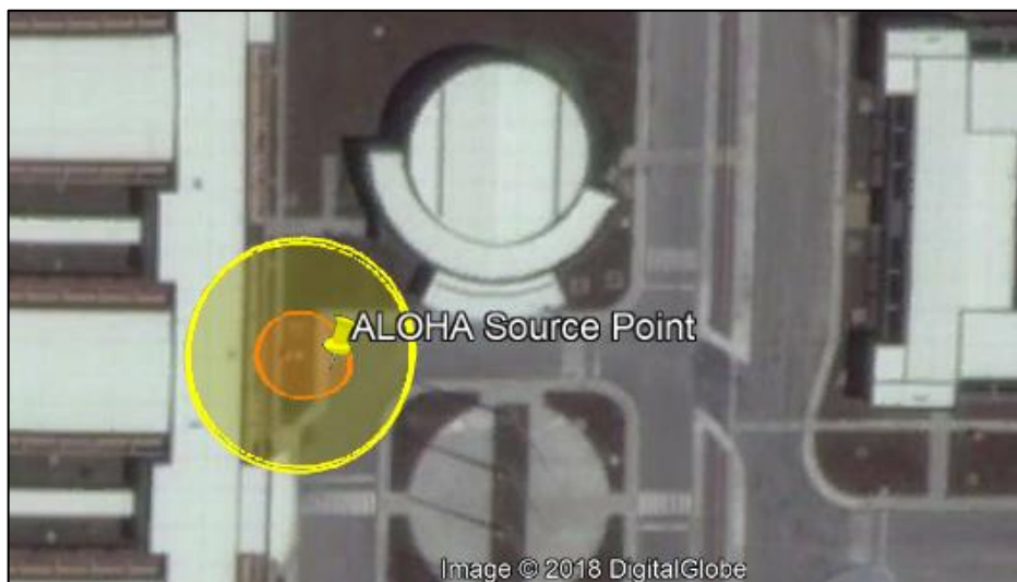
Figura 36 - Possíveis alcances de uma explosão para rupturas e fissuras: trecho 8
