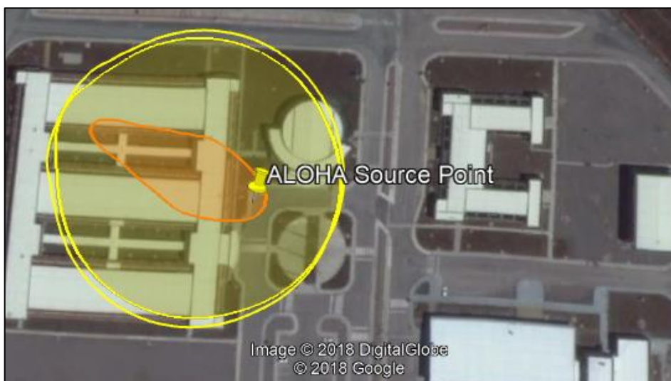
Figura 31 - Possíveis alcances de uma explosão para rupturas e fissuras: trecho 5
