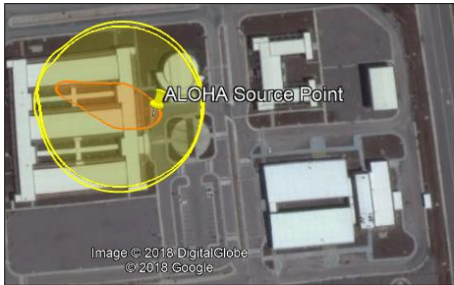
Figura 29 - Possíveis alcances de uma explosão para rupturas e fissuras: trecho 4
