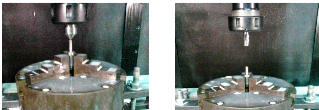
Figura 66. Usinagem das roscas nos pinos NiTi com 6 mm de diâmetro. (a) Ponteira de centralização dos pinos. (b) Detalhe do pino montado na placa de três castanhas.
