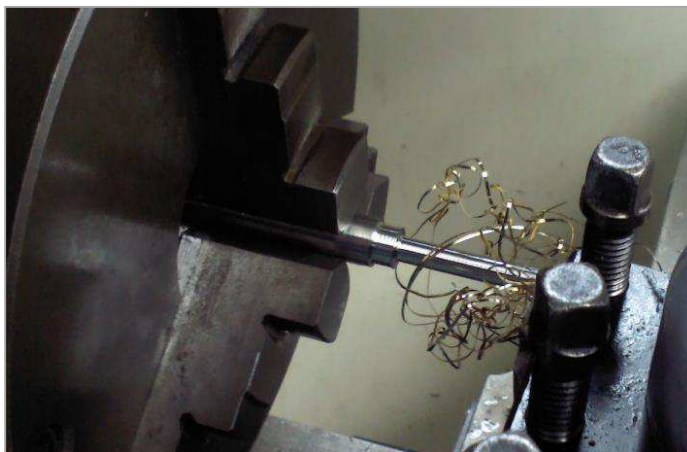
Figura 61. Fabricação de pinos de LMF NiTi através da usinagem de barras em torno mecânico.
