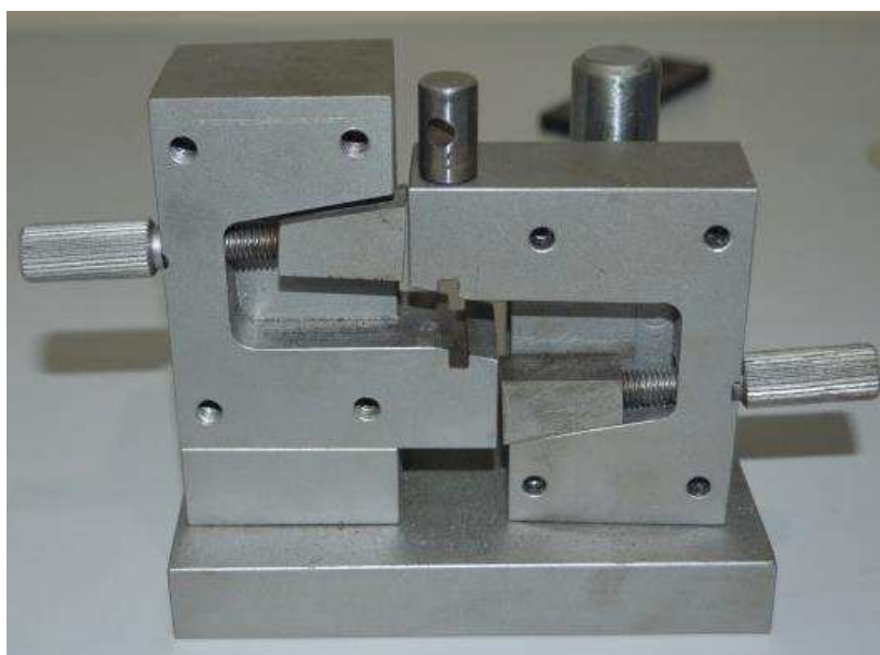
Figura 112 - Protótipo confeccionado para o ensaio ASTM 5379.
