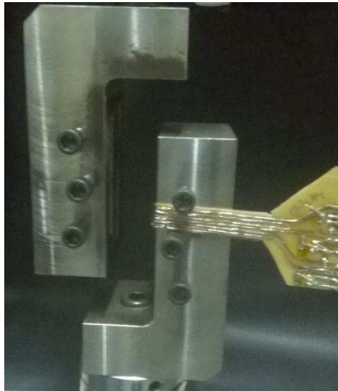
Figura 175 - Dispositivo V-Notched Rail Shear antes da realização do ensaio.
