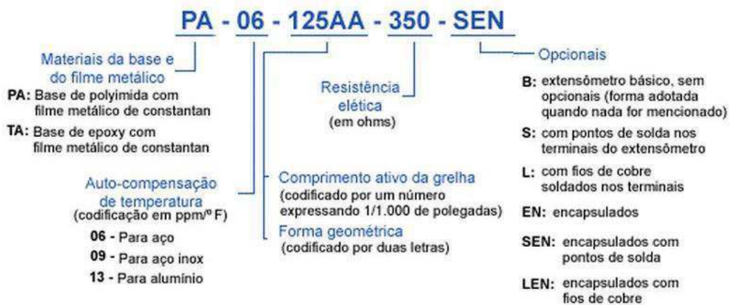
Figura 31 - codificação utilizada pelo fabricante de extensômetros Excel sensores [Fonte: http://www.excelsensor.com.br ]
