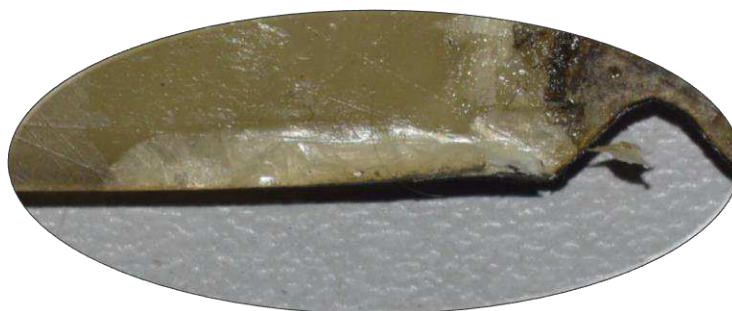
Figura 124 - Detalhe da superfície de contato do corpo de prova com o fixador após a realização do ensaio.
