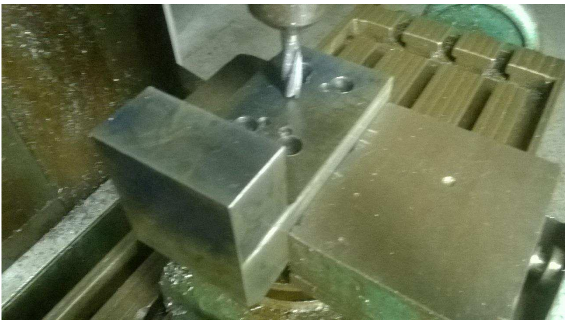
Figura 172 - Dispositivo V-Notched Rail Shear sendo usinado na Fresadora Universal da UFCG.
