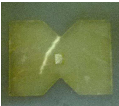
Figura 179 - corpo de prova V-Notched Rail Shear ensaiado.
