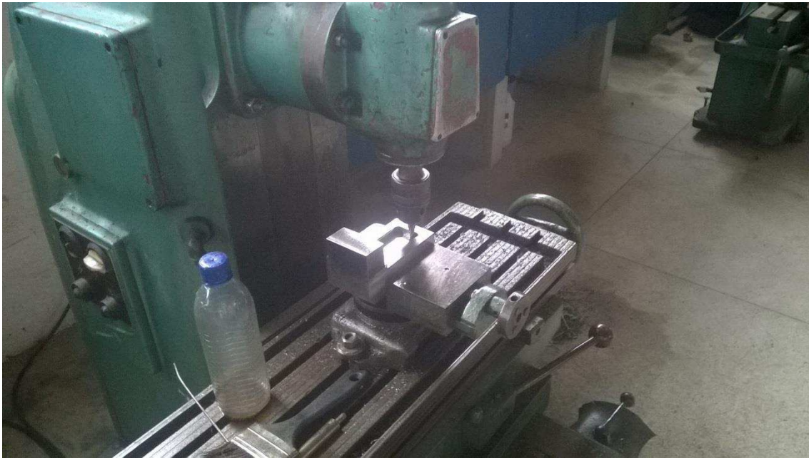
Figura 171 - Dispositivo V-Notched Rail Shear sendo usinado na Fresadora Universal da UFCG.
