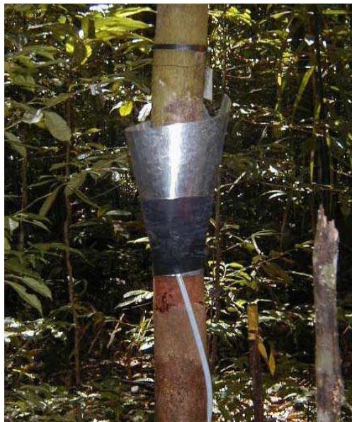
Figura 12. Detalhes do anel coletor utilizado para captar a quantidade de água escoada pelos troncos das árvores e drenada pelas mangueiras plásticas para um reservatório na superfície
