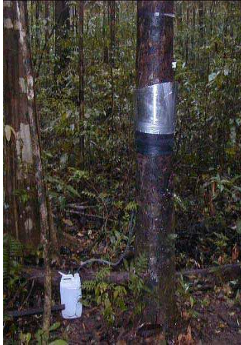
Figura 11. Anel coletor para captação da água escoada pelos troncos das árvores e o reservatório no solo conectado por uma mangueira plástica
