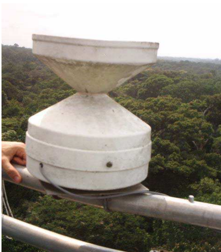
Figura 9. Pluviógrafo instalado no topo da torre micrometeorológica
