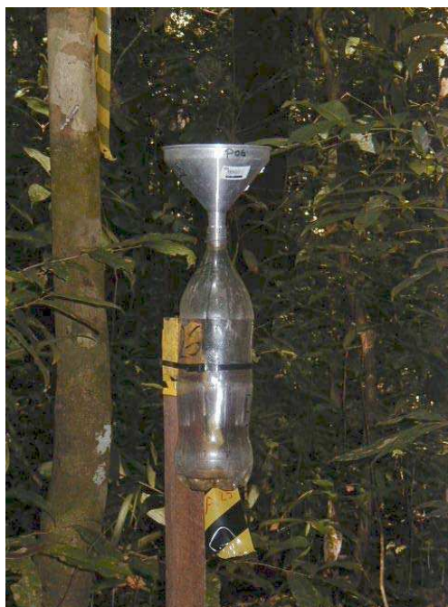
Figura 10. Pluviômetro utilizado para quantificar a precipitação interna
