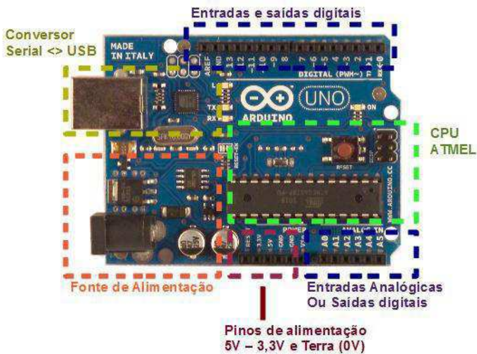
Figura 33 - Distribuição dos blocos na placa Arduino.
