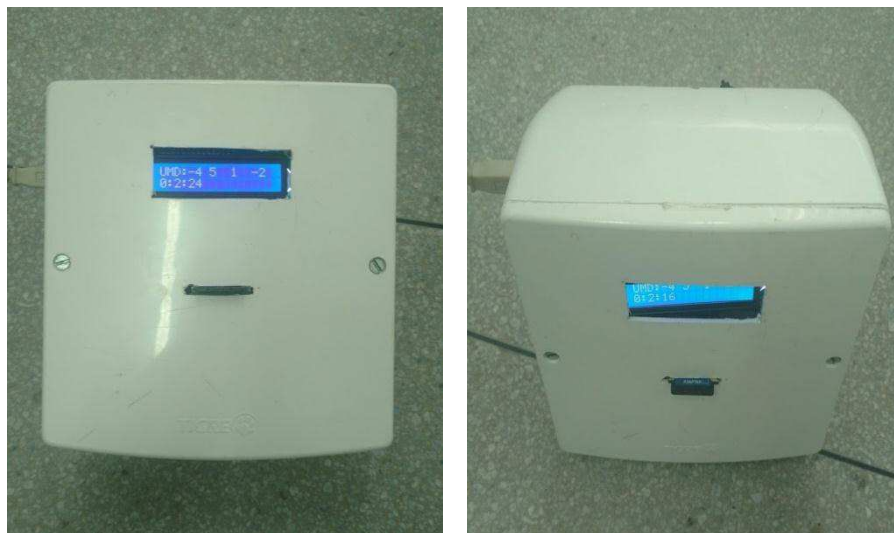
Figura 35 - Apresentação do compartimento do cartão SD e do display LCD.
