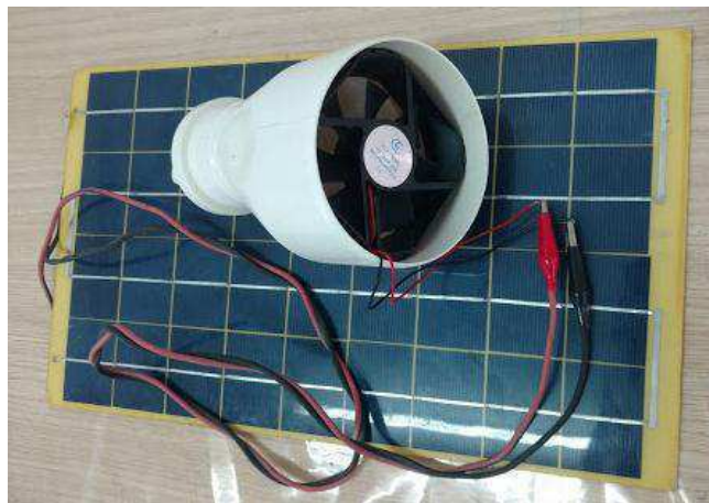
Figura 30 - Montagem do sistema de exaustão do secador.
