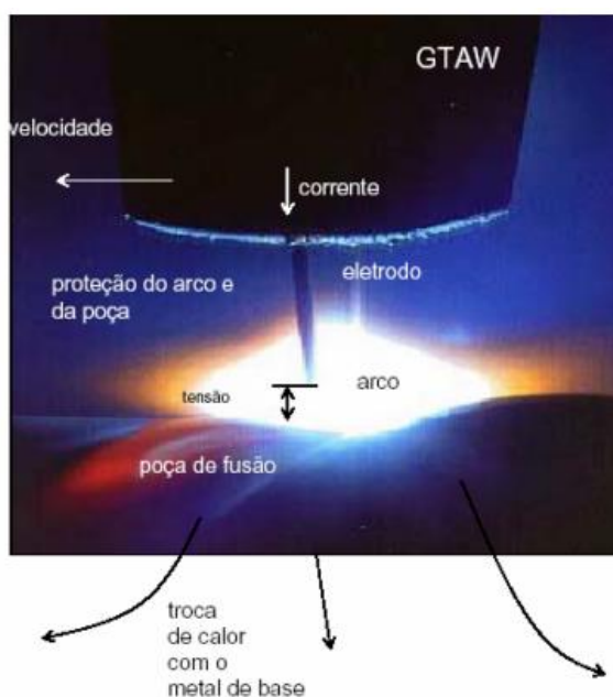
Figura 4: Variáveis do processo de soldagem GTAW.
