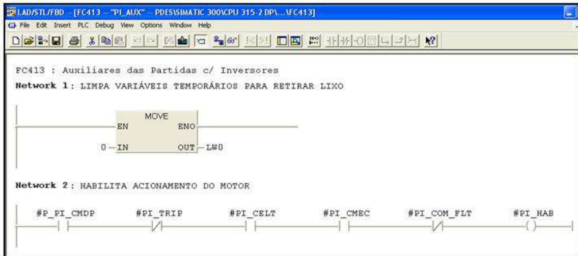
Figura 4.29 - Detalhe da FC413 - Lógica de habilitação da partida motobomba.
