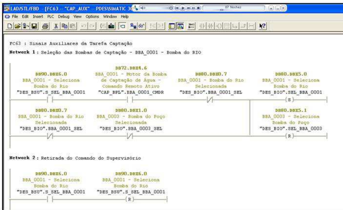
Figura 4.27 - Detalhe da FC63 - Lógica de seleção da Motobomba operante.
