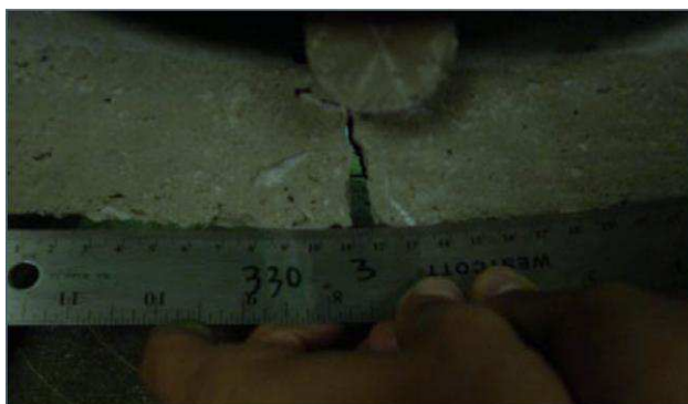
Figura 29 – Fissura no corpo de prova durante o carregamento.
