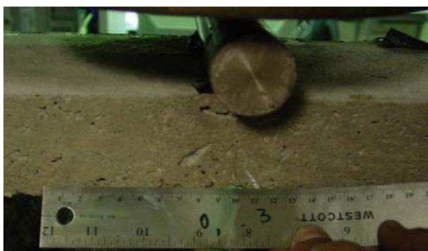
Figura 30 – Corpo de prova após o descarregamento e aquecimento dos fios de LMF.
