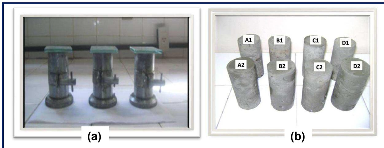
FIGURA 9 – (a) Moldagem dos corpos de prova e (b) Corpos de prova após estabilização por solidificação com os tratamentos A, B, C e D aptos à avaliação
