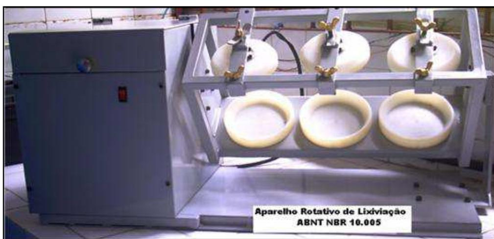
FIGURA 10 – Aparelho Rotativo de Frascos para Lixiviação
