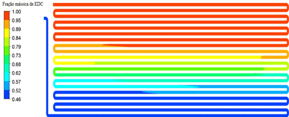
Figura 40 – Fração mássica de MVC ao longo do reator.
