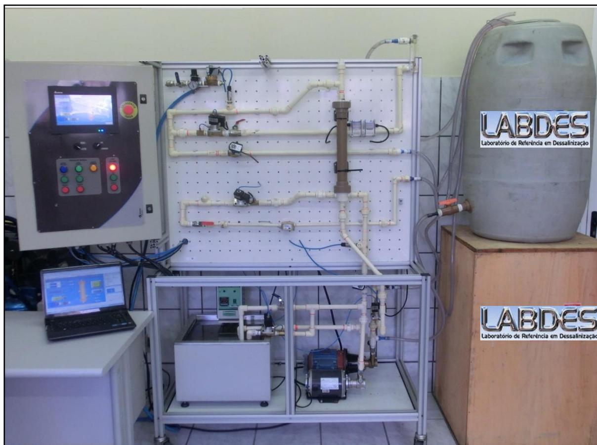
Figura 4.10 – Sistema com automação para processos de separação água/óleo com membranas cerâmicas.
