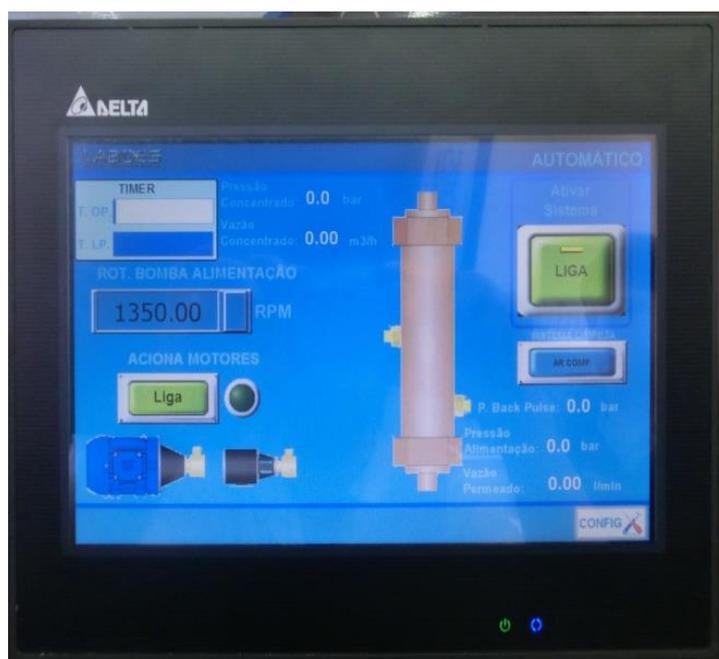
Figura 4.13 – IHM *touch screen* para monitoramento e controle do sistema.
