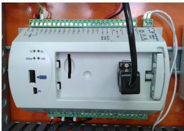
Figura 4.14 – *FieldLogger* da NOBUS para registro e aquisição de dados da variáveis de controle do sistema.
