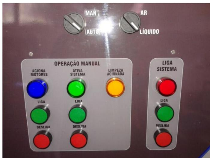
Figura 4.11 – Painel com botoeiras e chaves de seletoras para o controle manual do sistema de separação.
