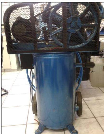
Figura 4.19 – Compressor de Ar comprimido utilizado no processo de limpeza (*backpulse*).
