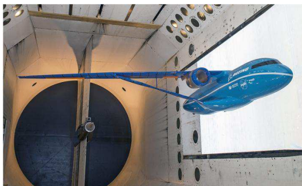
Figura 12 - Sistema de montagem em túnel de vento Sidewall
