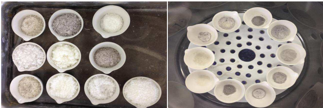
Figura 10- Ilustração das amostras de Colágeno Antes (imagem à esquerda) e Depois (imagem à direita) da queima na mufla
