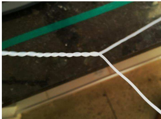
Figura 6 - Processo de confecção do fio duplo torcido
