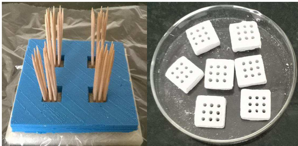
Figura 12 - (a) Moldes de silicone montados com palitos de madeira; (b) Scaffolds de HA.
